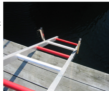
Redningsstige med beslag anvendes som løftekroge. Stigen kan flyde.
